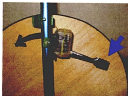
↑ 青矢印部分が数取り器を押すと共に、シャフトをはじいて音を出す
